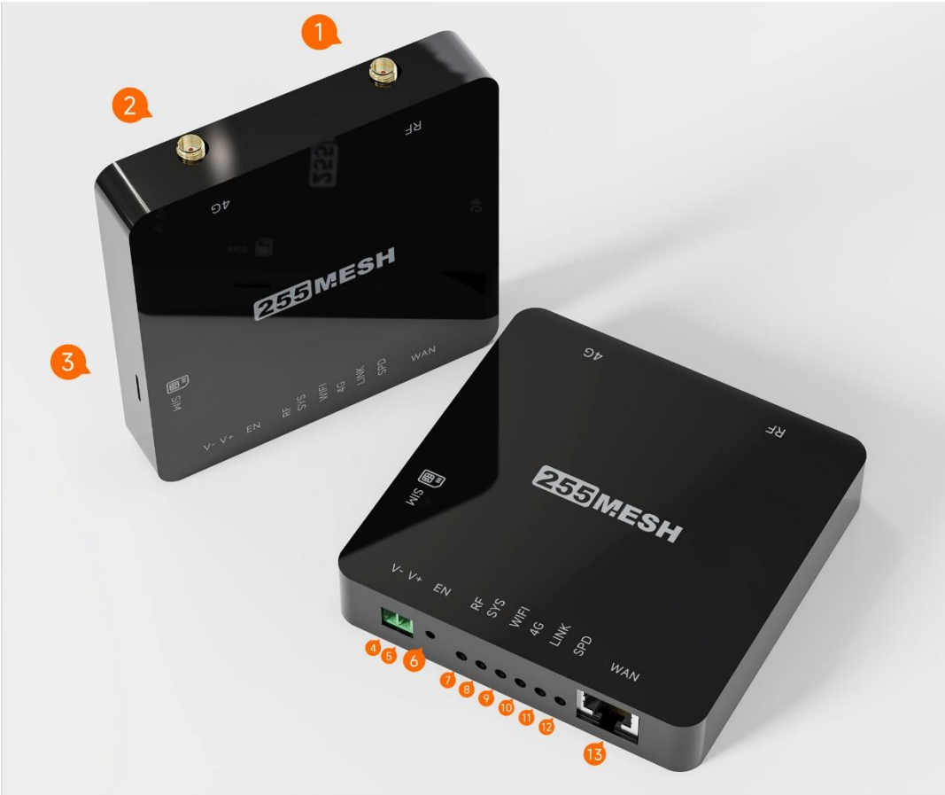
图 2.2 255MG-901 室内网关引脚图
