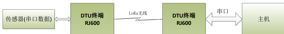
图 2 点对点数据采集系统框图
